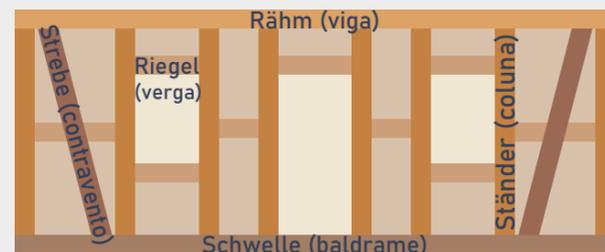
Técnica construtiva trazida pelos imigrantes alemães, consiste em peças de madeira unidas por encaixes, sem nenhum prego ou parafuso! As peças encaixadas formam uma estrutura em treliça, altamente resistente a forças em todas as direções.
